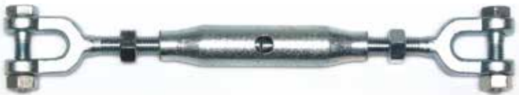
Wantenspanner nach DIN 1478 verzinkt, mit 2 Gabeln und Kontermutter, evtl. auch mit 2 Ösen zur Verspannung von Holzkonstruktionen oder ähnliches
