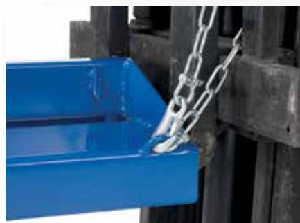
Kettensicherung gegen Abrutschen von den Gabelzinken
