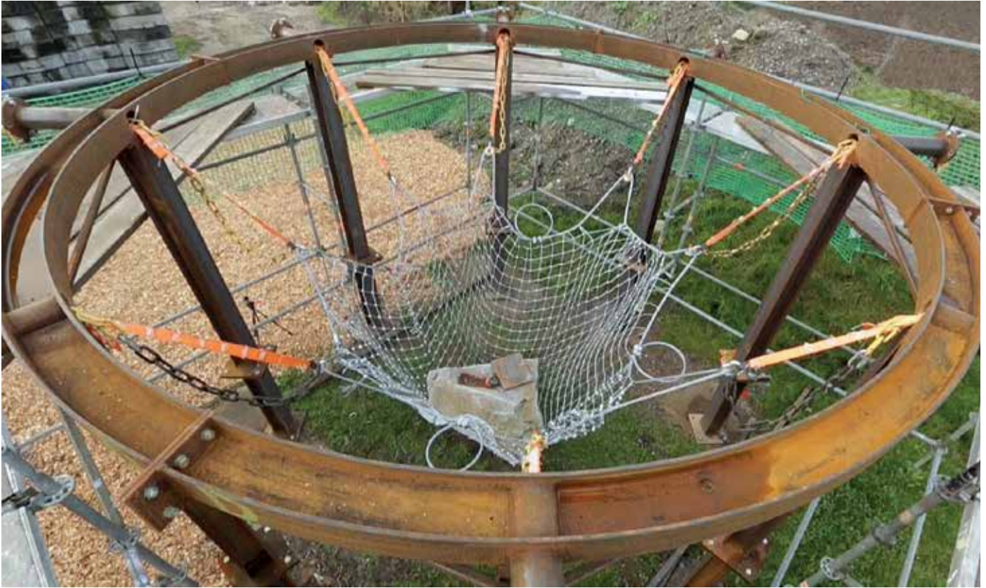
Ist-Zustand nach dem Fallversuch
