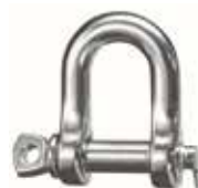
Sicherheitsschäkel Niro-Schäkel Typ HFS G 6 geprüft, gerade Form, gestempelt, passiviert, mit Schraub-Bolzen, außen mit Splint
