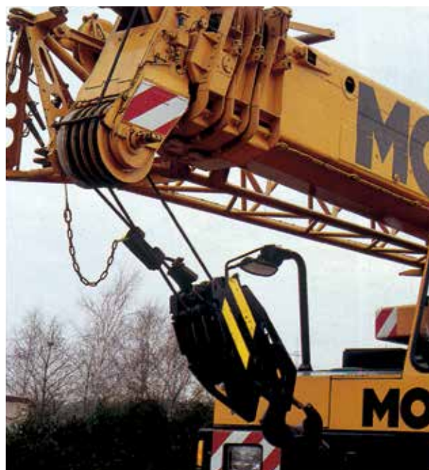
Hubseile, drehungsarm in 19 x 7 EN 12385-4 früher DIN 3069
